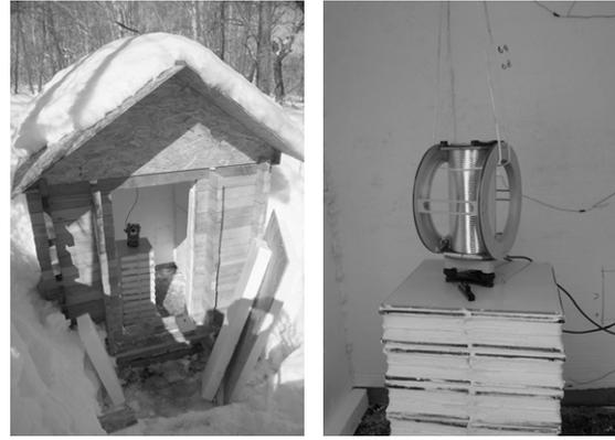
**Figure 7.** Vector/scalar Overhauser magnetometer POS-4. PET, Paratunka (Petropavlovsk).
